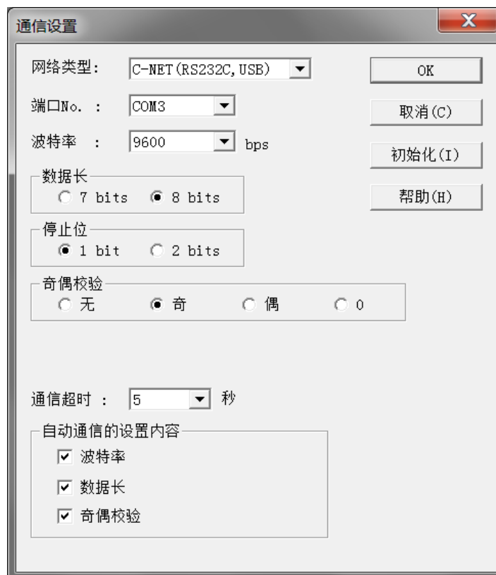
图 5.1-3 松下 FP0 系列 PLC 编程软件的设置
